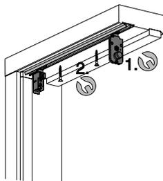
2. Flügelführung oben links und rechts lösen und rausnehmen
