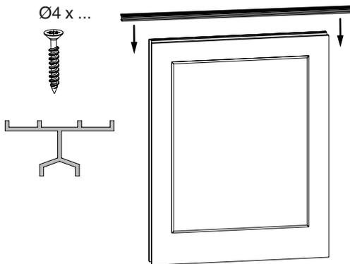
1. halbe Führungsschienen Schrauben lösen und rausnehmen
